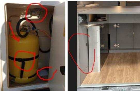
Armario con la bombona, regulado, reja de ventilación al suelo, sistema de fijación y ubicación
